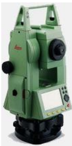
5-суре-Leica TC 1101 тахеометрі
